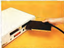
Il collegamento dell'interfaccia disco all'apposito slot. Nella foto di sinistra il connettore che si realizza una volta che il cavo è completo.
